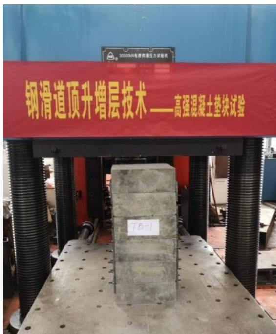
▲ 高精度高强度混凝土垫块试验
