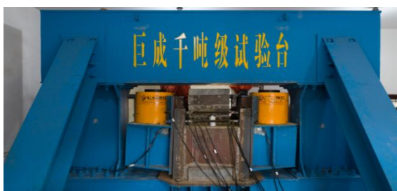
▲ 钢滑道静载试验
