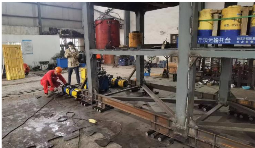
▲同步顶推平移试验
