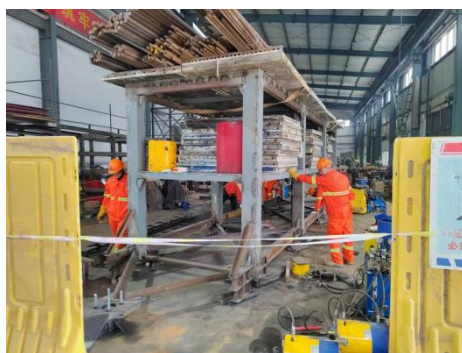
▲轴心在平面外的旋转试验
