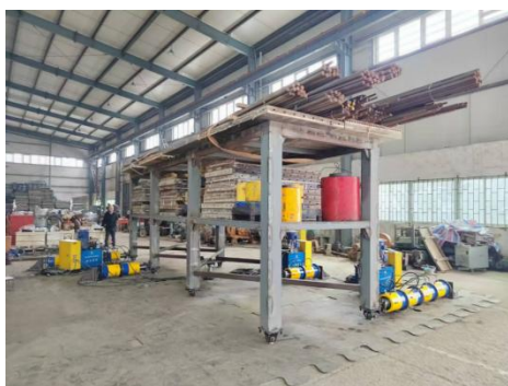
▲轴心与形心重合的旋转试验
